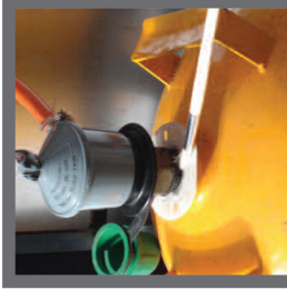
Anschluss des Reglers an die Gasflasche
