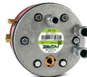
Riduttore-vaporizzatore tipo monostadio a membrana a pressione positiva, compensato con scambiatore di calore acqua-gas, valvola di sovrappressione interna. È disponibile in due versioni, ZETA N (normale) e ZETA S (super). Il riduttore si presenta molto compatto e con ingombri contenuti.
