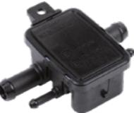
Questo componente include al suo interno 3 sensori differenti che misurano la pressione del gas dopo i regolatori di pressione, la pressione assoluta del collettore (MAP) e la temperatura del gas a monte degli iniettori.
