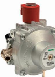
Riduttore metano monostadio, che mantiene stabilizzata la pressione di erogazione sfruttando la pressione di entrata del gas, aumentando o diminuendo la forza applicata alla parzializzazione del gas stesso.
